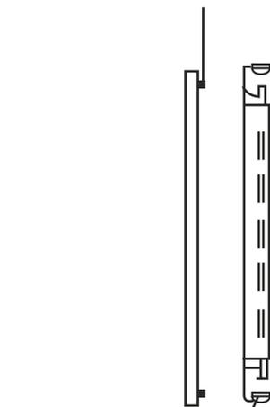
Putzrahmen mit eingesetzter Frontplatte und umlaufender Dichtung (werkseits)
