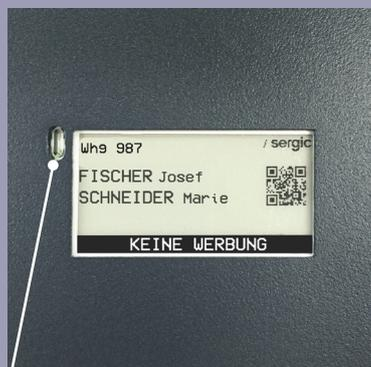
LED-Anzeige für Batteriewechsel
