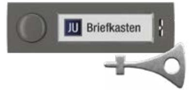
1. Für den Wechsel des Namensschildes bei Kombitastern wird der mitgelieferte Schlüssel in die dafür vorgesehene Öffnung am rechten Rand eingeführt und anschließend im Uhrzeigersinn um 90° gedreht. Das Namensschild kann nun herausgezogen werden.
