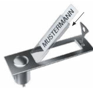
3. Bevor das Namensschild wieder eingesetzt werden kann, muss der Schlüssel entfernt werden. Dafür wird es zunächst am linken Rand angelegt und mit etwas Druck am rechten Rand hinein gedrückt bis dieses einrastet.
