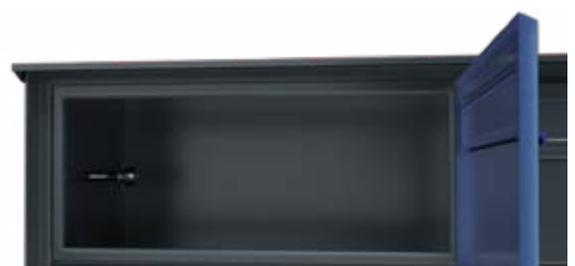
4. Befestigen Sie nun den Ständer mit Hilfe der beigelegten Sechskantschrauben und der Unterlegscheiben im obersten und untersten Briefkasten. Wir empfehlen aufgrund des beengten Raumes einen Ratschen - Schraubenschlüssel mit der Schlüsselweite SW 10 zu verwenden.
